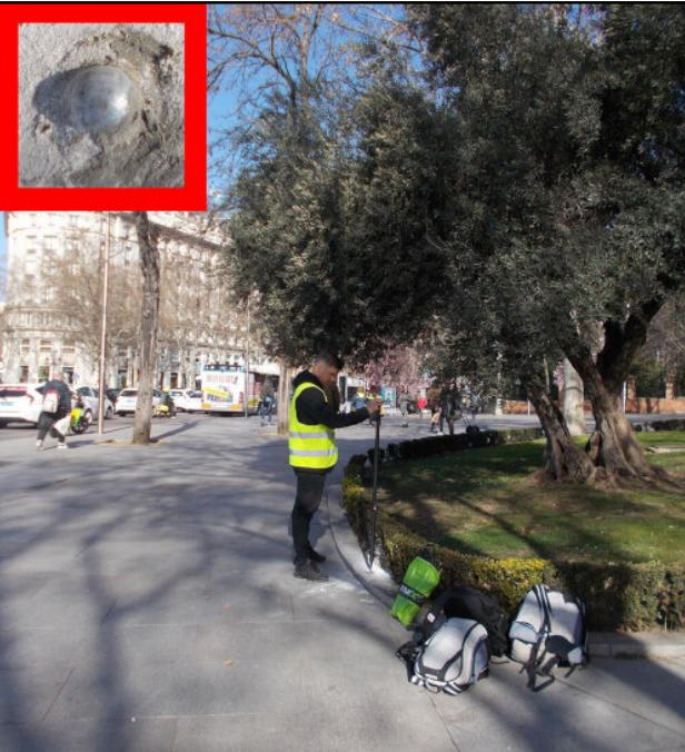
**Datos Geodésicos:****Altitud ortométrica:** 626,1485 m.**Geopotencial:** 613,625 u.g.p.**Gravedad en superficie:** 979972,63 mgals. *Observada***Cálculo:****Coordenadas Geográficas ETRS89:****Longitud:** - 3° 41' 29,8593"**Latitud:** 40° 24' 33,0770"**Altitud elipsoidal:** 677,155 m.**Precisión:** ± 0,05 m.**Reseña:**
