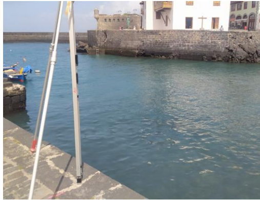
Figura 2: Trabajos de nivelación del mareógrafo de Puerto de la Cruz, abril 2022
