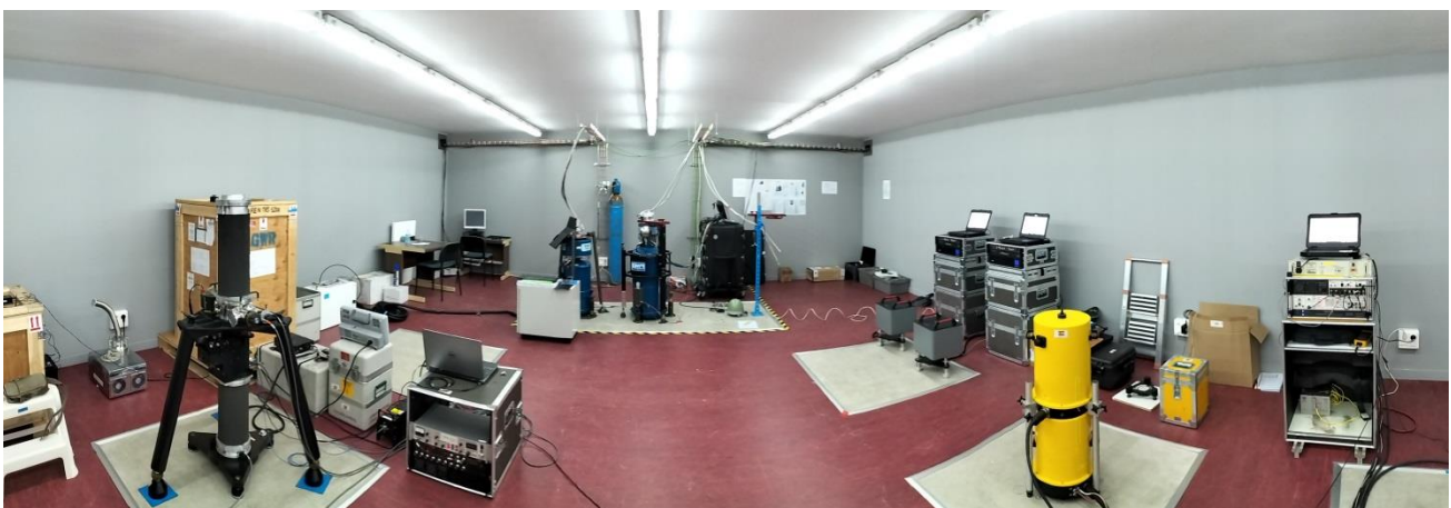
Figura 3: Gravímetros absolutos y relativos en el pabellón de gravimetría del Centro Astronómico de Yebes.
