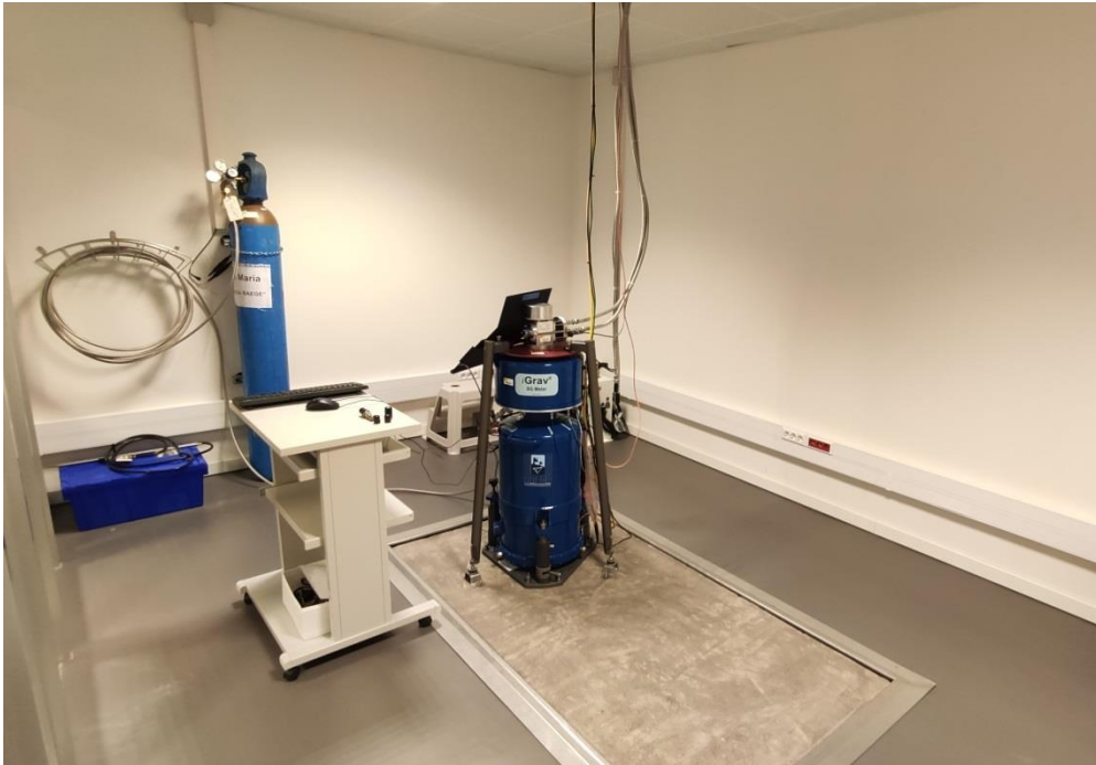
Figura 4: Gravímetro superconductor iGrav#051 en el observatorio de Santa María.
